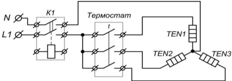
Схема подключения 2. Питание 380 В, блок ТЭН 220В.
