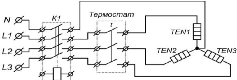
Схема подключения 3. Питание 380 В, блок ТЭН 380В (изготавливаются под заказ).
